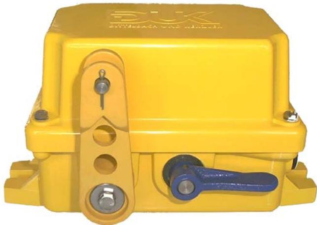
Durch die Ausstattung mit zwei Spannfedern unseres Types SPF-W wird die Forderung der DIN EN 418 Abs. 4.5.2 (automatischer Not-Aus Befehl bei Seilriss) erfüllt.
