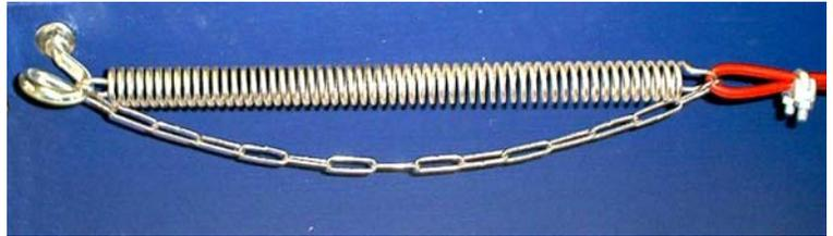
Spannfedern werden paarweise, links und rechts vom Seilzugnotschalter, innerhalb der Reißleinen angeordnet und vorgespannt, um bei einem eventuellen Riß einer Reißleine auf einer Seite mit der Vorspannung der anderen Seite den Schalter zu betätigen.
